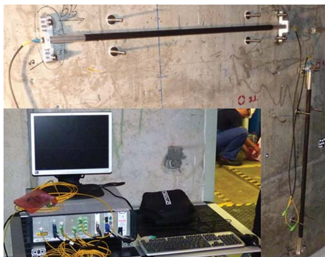
Obr. 2 – Senzory II. generace instalované na 1. výrobním bloku JE Temelín, ve výřezu měřicí aparatury integrovaným PC
